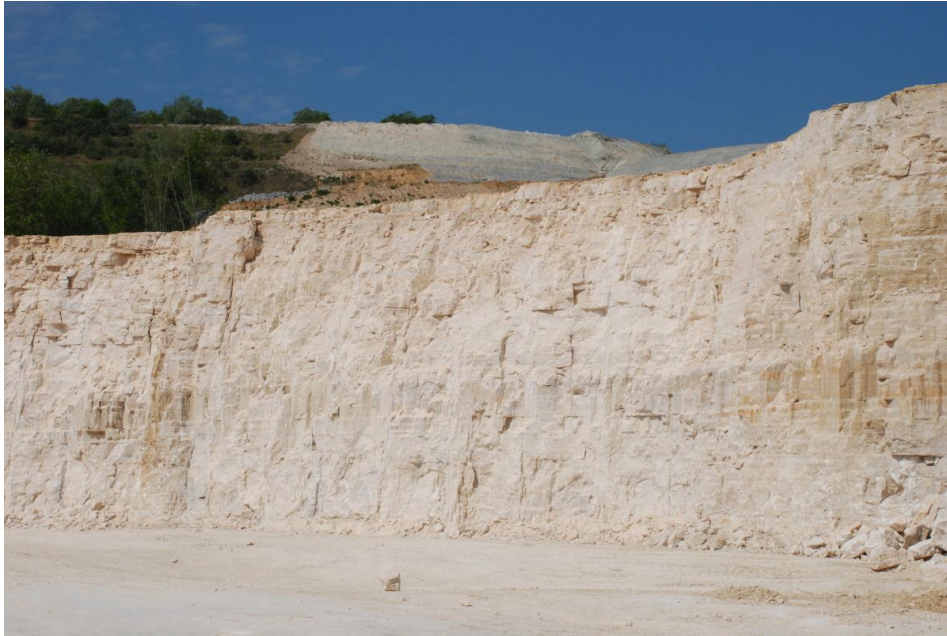
Illustration 1: Célèbre carrière de gypse dans laquelle on observe, de bas en haut, un empilement stratigraphique de gypse, de marnes et de sable de Fontainebleau (Cormeilles-en-Parisis, Val-d'Oise, 2007). © BRGM - François Michel
